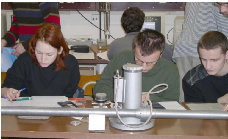
Obr.2. Prietok – meranie prevodovej charakteristiky clony.
